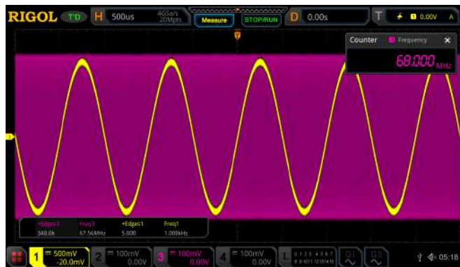
Figura 2.4: Observe y mida con precisión dos señales con grandes desviaciones de frecuencia. La medición de hardware con memoria completa puede medir el valor de frecuencia exacto de las formas de onda con 340k bordes ascendentes.
