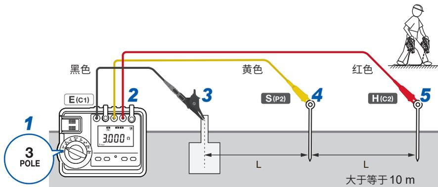
如果将接地电极从设备上断开，则可正确测量接地电阻值。请从设备上断开接地电极，然后开始测量。无法从设备上断开接地电极时，请使用 3 电极法、MEC 进行测量。
