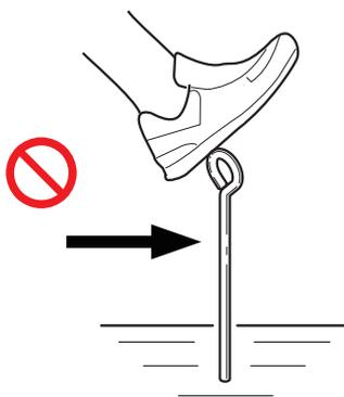
请勿向辅助接地棒施加横向的力，以免棒产生弯曲。
