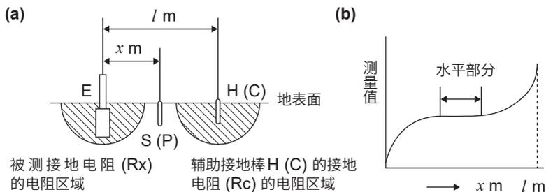
通过在 E-H (C) 电极之间使用选件 L9843-51、L9843-52 与 L9843-53, 可离开最大 50m 距离。另外, 也可以在如图 (b) 所示的水平部分范围内增大 E-S (P) 电极之间的距离。离开 50m 或以上时, 原则上也可以进行测量, 但无法保证测量结果。
