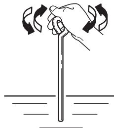
用手握住辅助接地棒的圆圈部分，一边旋转一边拔出。
