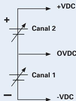
Esta función es útil para alimentar circuitos bipolares y dispositivos.
