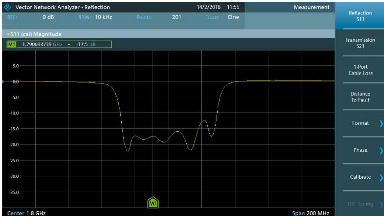
R&S®FPC1500: medición de magnitud S_{11} con la opción R&S®FPC-K42
