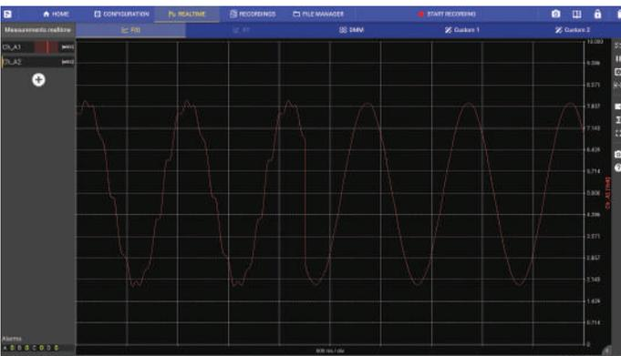
Reduzca ruido no deseado con filtros analógicos y digitales integrados. Los filtros analógicos incluidos son: paso bajo de 100 Hz, 1 kHz, y 10 kHz, y los digitales son: paso alto, paso bajo, paso de banda y parada de banda filtrando de 10 mHz a 10 kHz.
